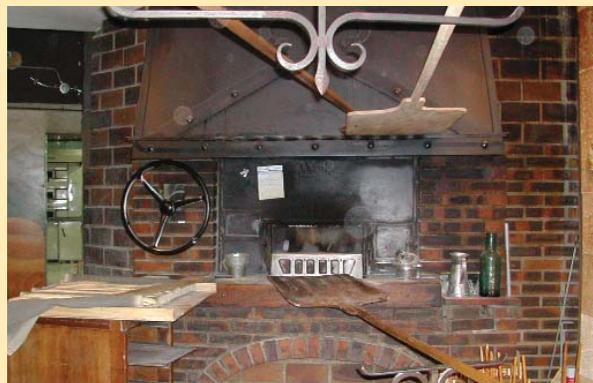
La sole tournante de ce four à bois Llopis est actionnée par le volant extérieur (à g.)
