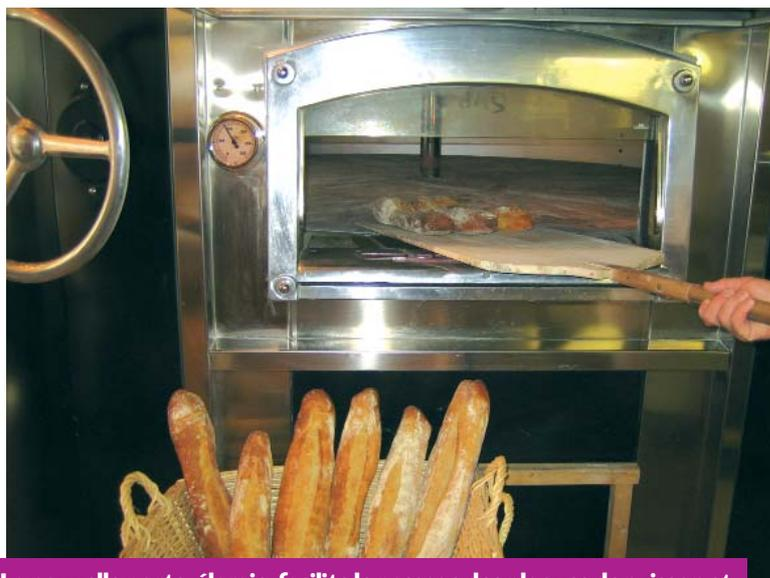
La nouvelle porte, élargie, facilite le passage des plaques de cuisson et surtout la rotation de la sole et les coups de pelle.
